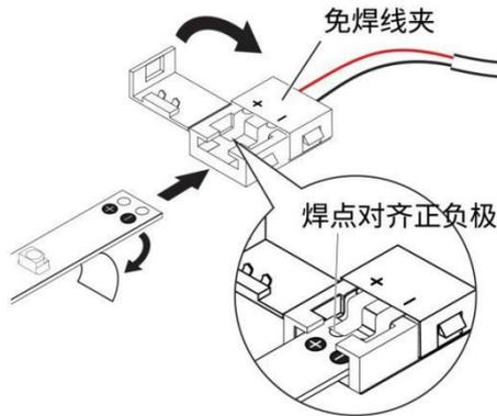
将灯条卡入免焊夹中。再合上铰链夹。
